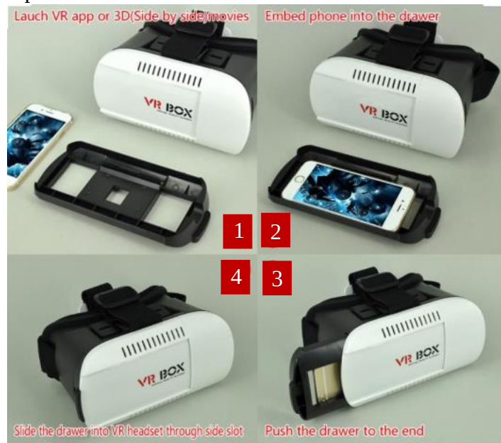
Gambar 9.28 Langkah Langkah Merangkai VR Box
